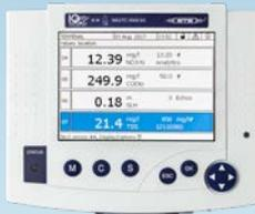
System 2020 mit großem Display zum Anschluss von mehr als 4 Sensoren - komplexes Messnetzwerk möglich.
